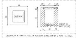
DETALHE-CAIXA DE ALVENARIA 30x30x40cm escala: s/e
