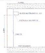
8 BLOCO AUTÔNOMO-ILUMINAÇÃO FIXA NO TETO SEM ESCALA
