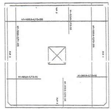
CX. D'ÁGUA - ARMADURA DA TAMPÃO
